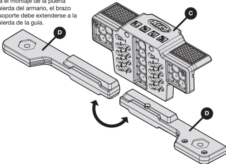
Para el montaje de la puerta derecha del armario, el brazo de soporte debe extenderse a la derecha de la guía.
